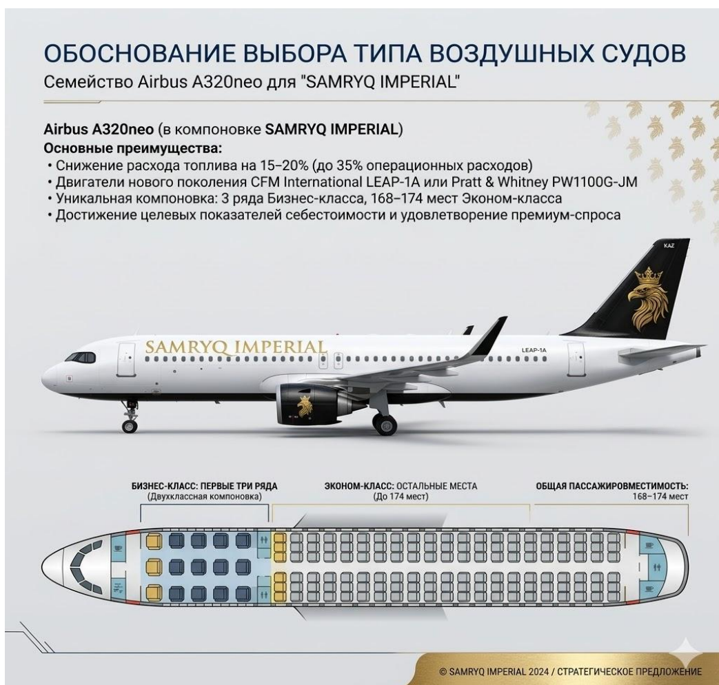
Рисинок 4 - Схема конфигурации ВС SAMRUQ IMPERIAL
